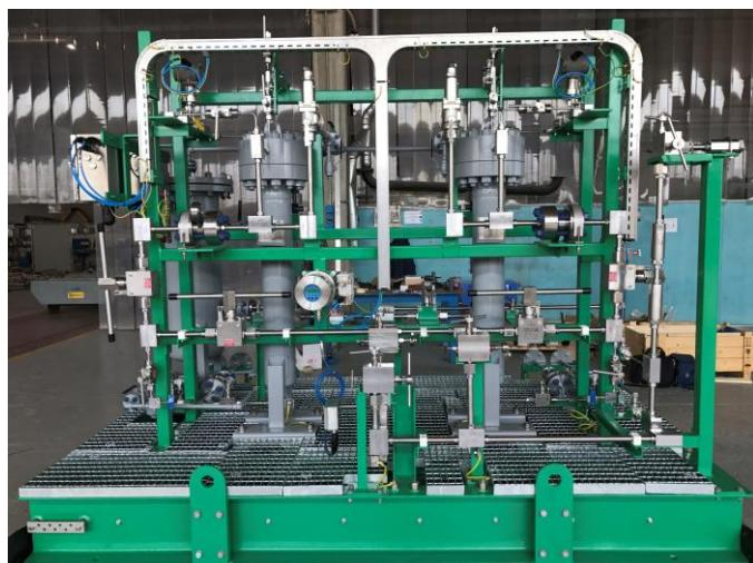
Questa tipologia di filtri può essere progettata per diverse applicazioni: la rimozione di particelle solide e la rimozione di particelle liquide (filtri coalescenti). Gli elementi filtranti possono essere realizzati in tutti i tipi di materiale metallico o plastico, poliestere, feltro, microfibra di vetro.
