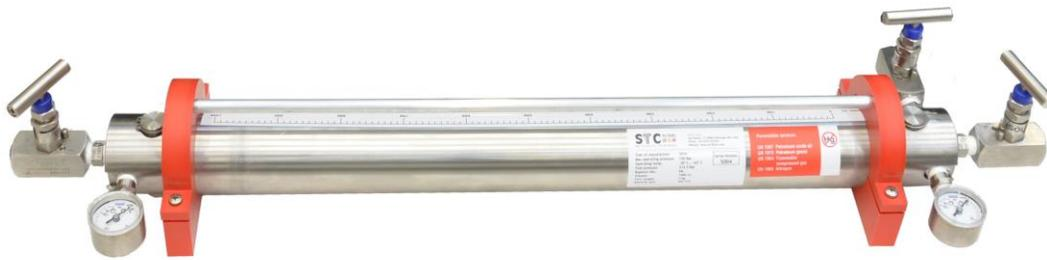
La parte inferiore del cilindro viene utilizzata per contenere il campione per la convalida dell'Analizzatore, mentre quella superiore viene utilizzata per spostare il pistone e il conseguente campione che spinge verso l'analizzatore.
